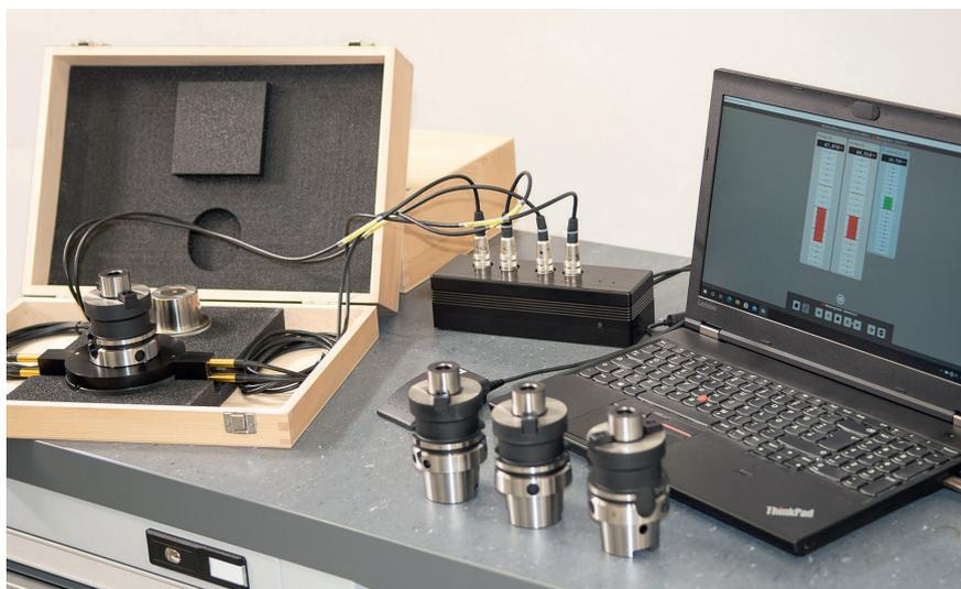
**1** Alles, was man braucht: Die smarte, portable HSK-Messlehre (links) benötigt keine zusätzlichen Messsäulen. Sie ermöglicht schnelle Messungen an HSK aller Größen © Kelch
